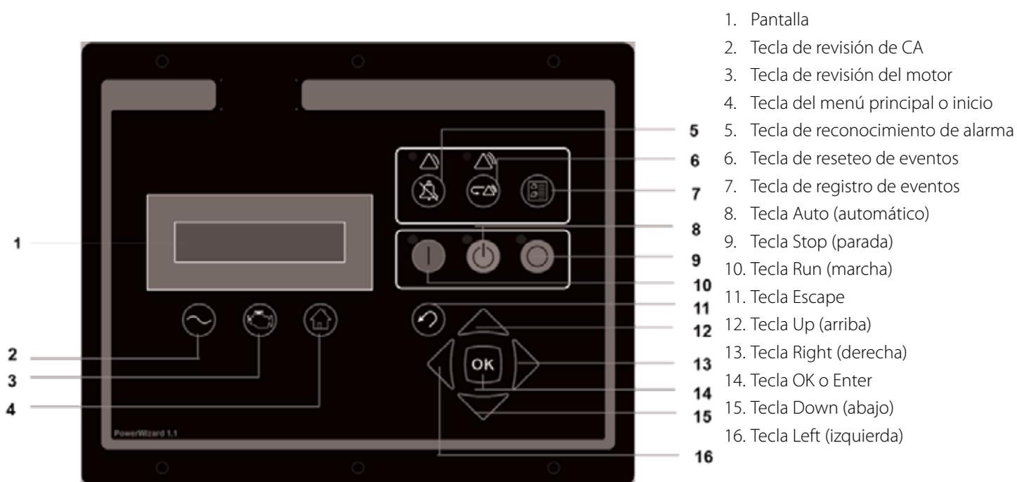
Figura 5.2: descripción del módulo de control PowerWizard
