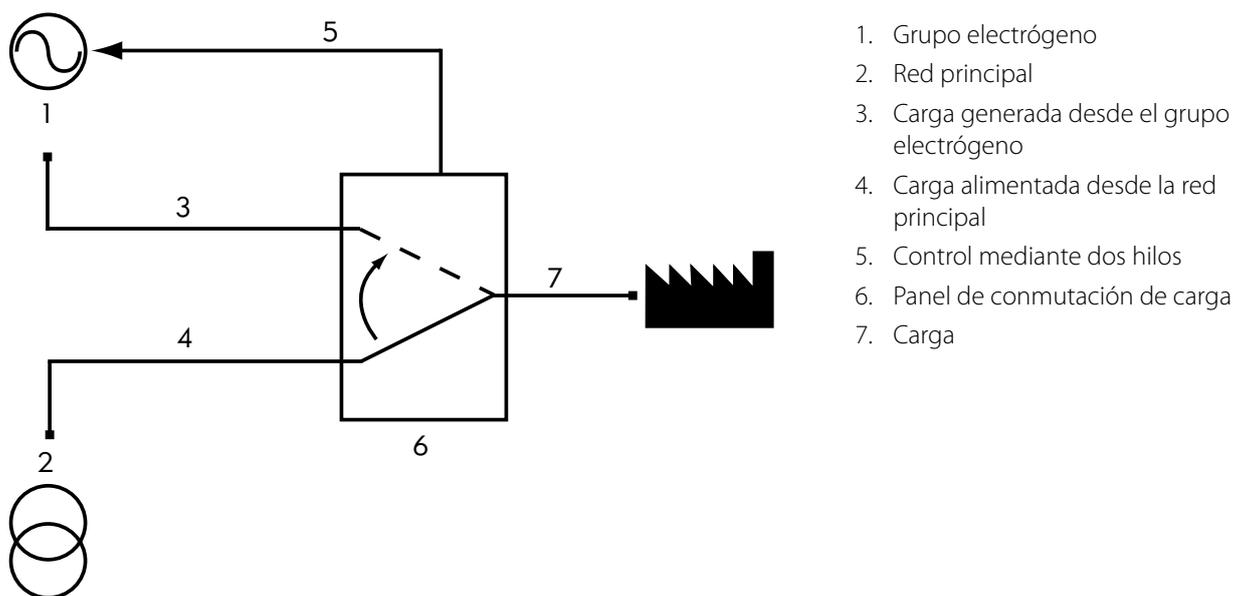
Figura 7.1: función de un panel de conmutación de carga
