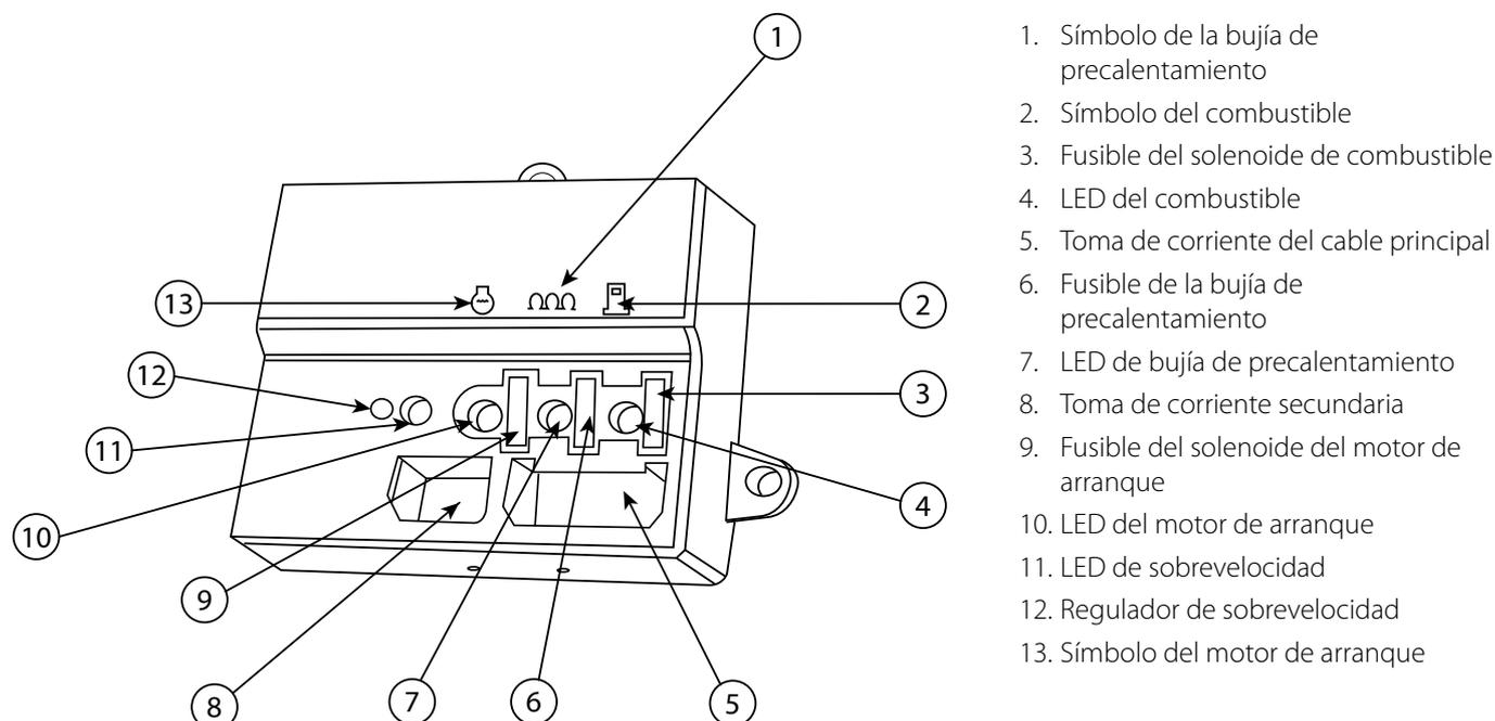
Figura 7.3: módulo de la interfaz del motor (EIM)
