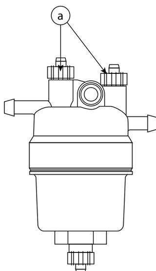
Figura 6.1. Ejemplo de prefiltro/separador de agua
