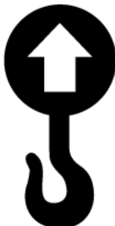
Symbole de point de levage/point d'ancrage
