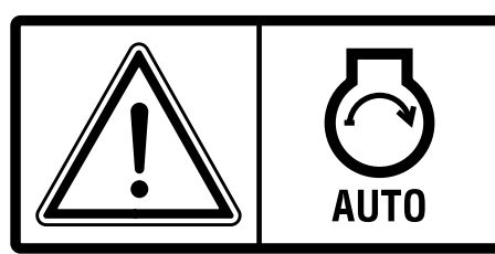
Attenzione: avviamento automatico
