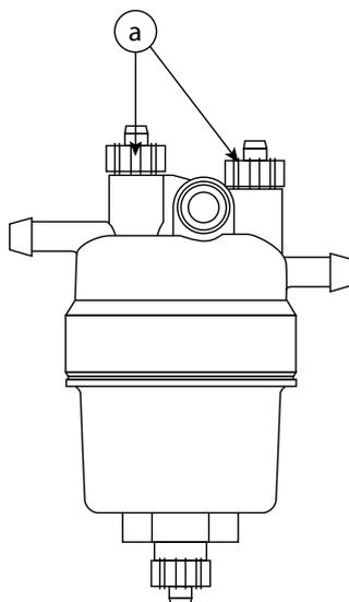
Figura 6.1 – Exemplo de pré-filtro / separador de água
