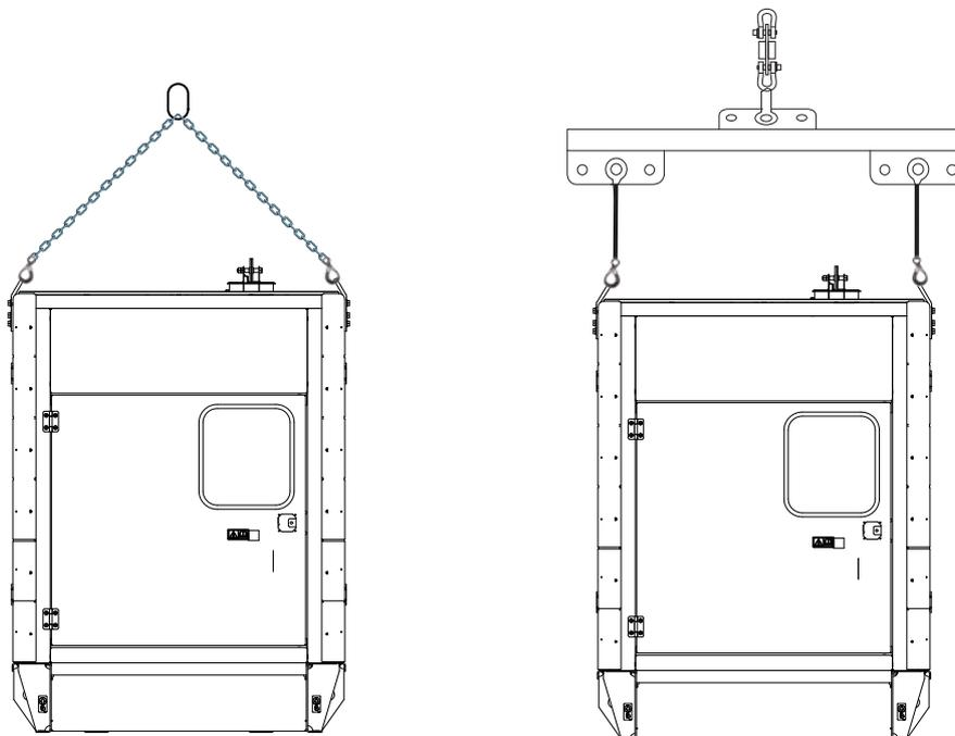
Figura 4.7 – Dois Pontos de Elevação
