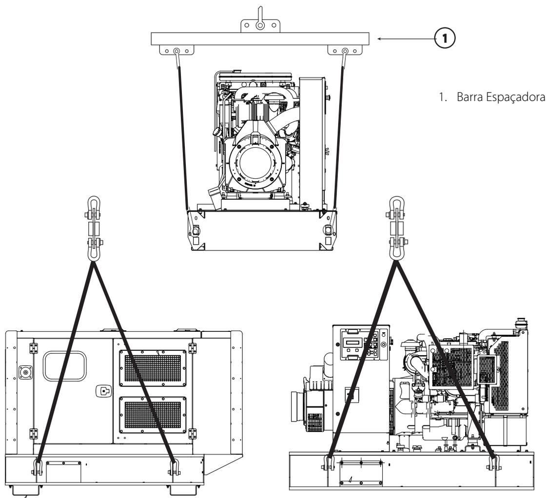
Figura 4.8 – Disposição de elevação adequada para instalação do grupo gerador (aberto e com estrutura de proteção)
