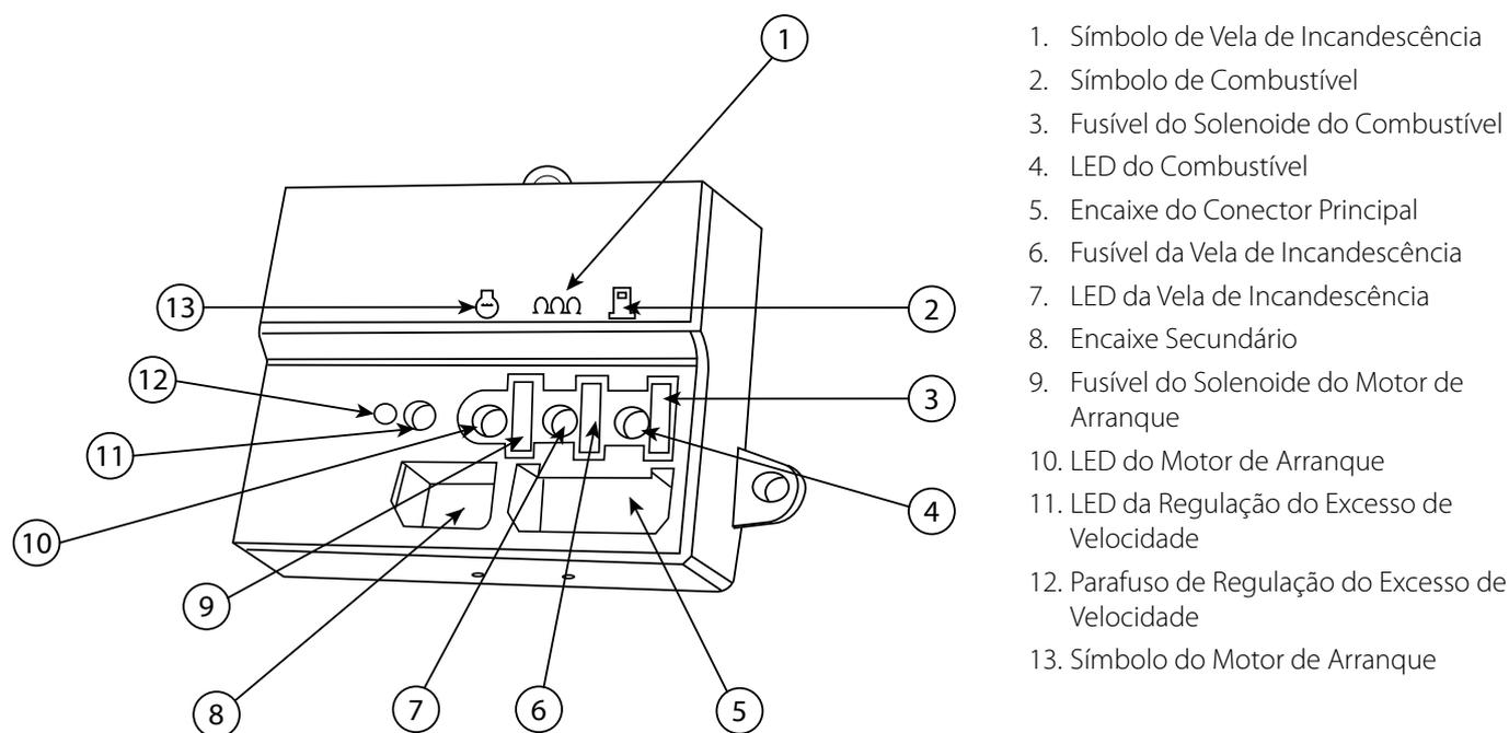
Figura 7.3 – Módulo de Interface do Motor (EIM)
