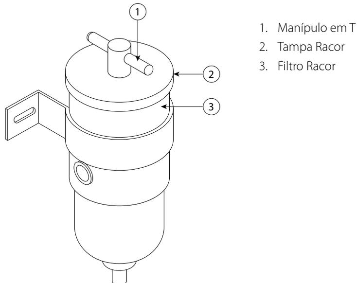
Figura 6.2 – Exemplo de um Racor
